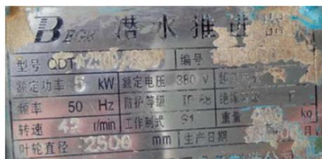
图2 国内某单位产 5kW 低速潜水推流器
