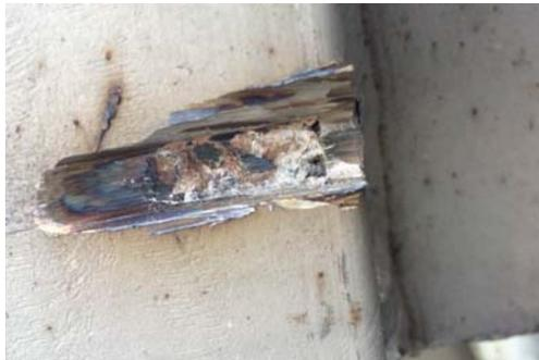
图 1 潜水推流式搅拌机升降导杆内浇灌的混凝土
