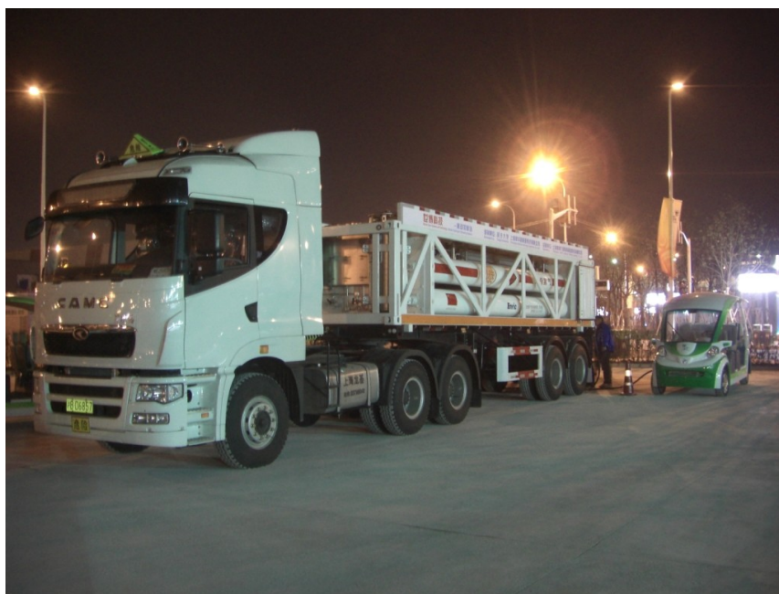
图 1：2010 上海世博会上加氢车为燃料电池观光车加注氢气
