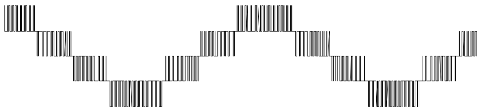
图 B. 16 二极管钳位式三电平逆变器的输出波形
