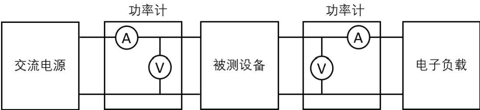
图 D. 1 嵌入式电源工作效率和功率因数测试连接图（单输入单输出场景）
