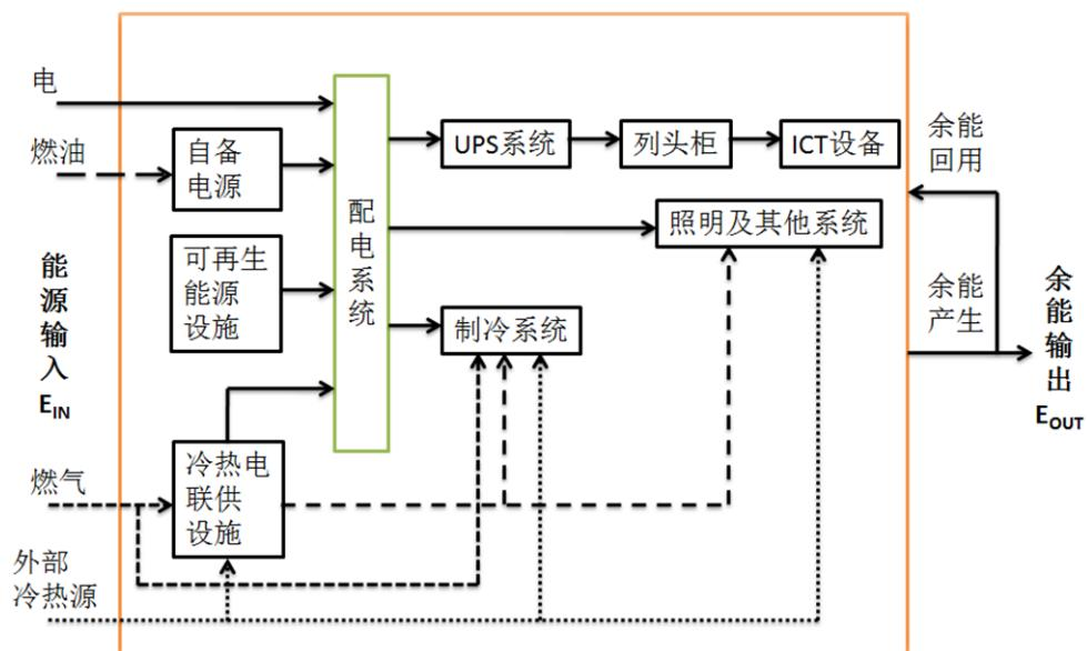
图 1 数据中心的能源边界示意图
