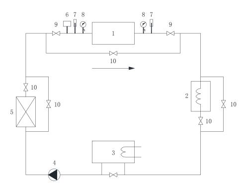
1——太阳能中低温蓄热装置; 2——冷却装置; 3———次加热装置; 4——循环泵; 5——二次加热装置; 6——流量传感器; 7——温度传感器; 8——压力表; 9——进出口阀门; 10——旁通阀门
